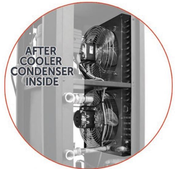
Beaucoup de fabricants de compresseurs à piston n'utilisent pas de réfrigérant final. L'air comprimé quitte le compresseur à une température avoisinant 100°C. Les sècheurs haute température de Drytec sont équipés d'un réfrigérant final afin de diminuer la température d'entrée.
