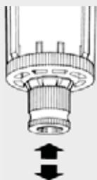
Le système de purge semi-automatique est du type normalement ouvert. Quand il y a de la pression dans le circuit le système de purge est fermé. En absence de pression dans la cuve, le système de purge est ouvert et les condensats peuvent s'évacuer vers l'extérieur par gravité. Avec le bouton en position centrale la purge est en position semi-automatique.
