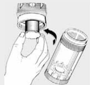
Avant démontage de la cuve, s'assurer que l'appareil n'est pas sous pression. Effectuer le démontage de la cuve avec une clef à compas  $\varnothing$  3 mm et de la cartouche comme indiqué sur le schéma ci-dessus.
