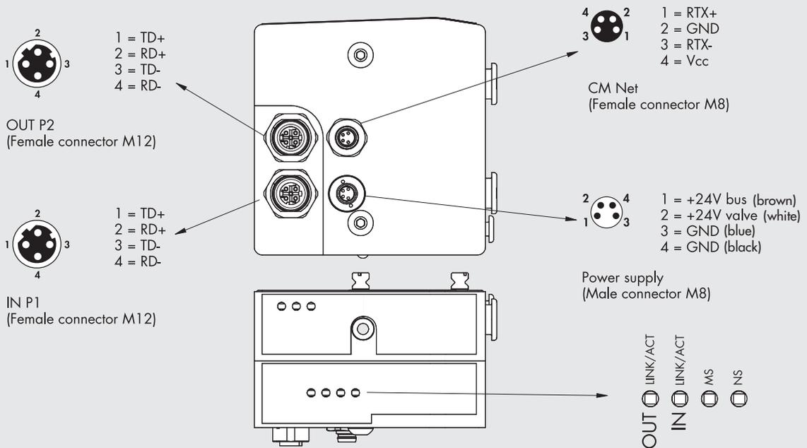
**2 - O** END-PLATE 1-11 EtherNet/IP OUTPUT
