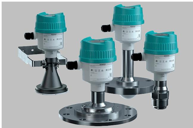
Les transmetteurs de niveau radar à 80 GHz de la série SITRANS LR500 permettent la surveillance en continu du niveau de liquides, de boues liquides et de solides dans les cuves de stockage et de process présentant pression et températures élevées ; plage de mesure jusqu'à 120 m (393 ft).
