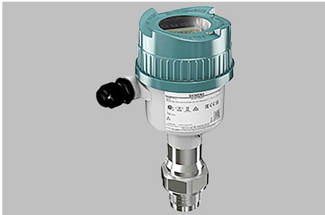
Le SITRANS LR510 avec antenne lentille, raccord fileté, permet la surveillance en continu du niveau de liquides, y compris de liquides corrosifs, et de boues liquides ; plage de mesure jusqu'à 30 m (98 ft). Le raccord process de petite taille est idéal pour les applications présentant des conditions de montage difficiles.
