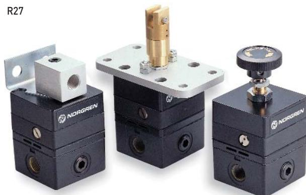
Régulateurs de haute précision qui fonctionnent à l'aide d'une chambre de contrôle à la place d'un ressort, offrant une meilleure sensibilité aux variations et une diminution de l'hystérésis
