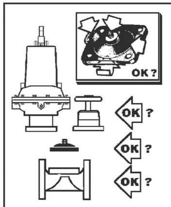
Assembler la membrane sur le compresseur sans effort excessif et mettre la tête du robinet dans la position naturelle de la membrane:
