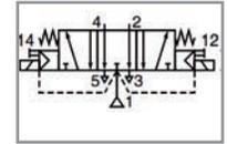
**Remarque** : il faut impérativement associer aux distributeurs, **deux** électrovannes pilotes conseillées, deux bobines électriques et deux connecteurs + choisir une embase (voir fin de cette section).
