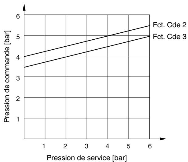
La pression de commande, représentée sur le diagramme ci-dessus en fonction de la pression de service (du fluide), sert seulement d'indication pour une utilisation sûre et pérenne de la membrane.
