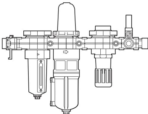
Le montage d'un pressostat en sortie permet de délivrer un signal électrique en cas de chute de pression importante - (pour la série 64 uniquement).
