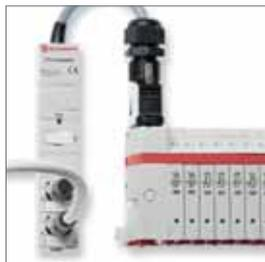
Possibilité de combiner les îlots VM10 et VM15 avec les modules d'entrées/sorties Norgren FD67 en utilisant un boîtier de raccordement multipole. Ceci permet le contrôle et les diagnostics de chaque sortie par l'intermédiaire du bus de terrain.
