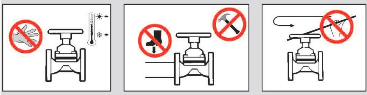
Un effort manuel est suffisant pour assurer la fermeture étanche du robinet. Ne jamais utiliser de clé ou serre tube pour fermer le robinet. Un effort excessif réduira la durée de vie de la membrane. Les pressions maximales de service sont basées sur une accessibilité normale à la manoeuvre du robinet. En cas de difficultés de manoeuvre il est possible d'équiper les robinets de grands diamètres de réducteurs manuels (contactez-nous)
